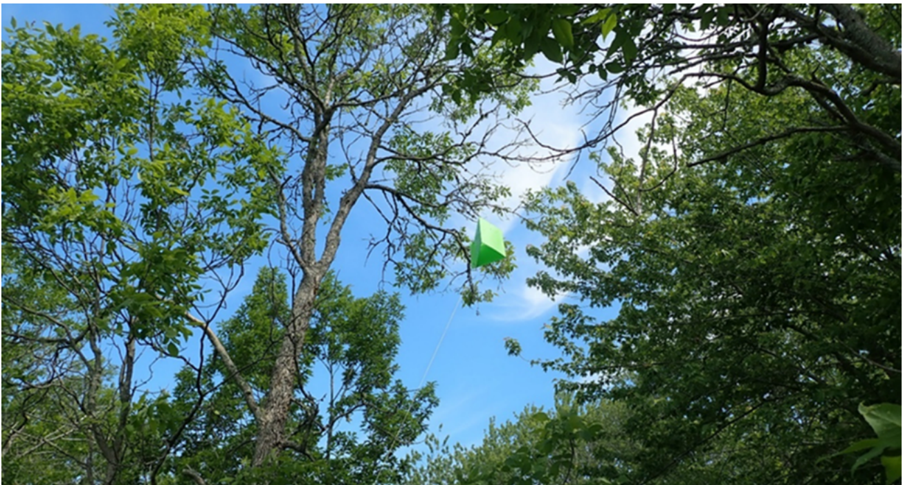
Image: Un piège à prisme vert accroché à la canopée d'un frêne. Ces pièges servent à surveiller la présence de l'agrile du frêne. Référence photographique : Eric Knopf
