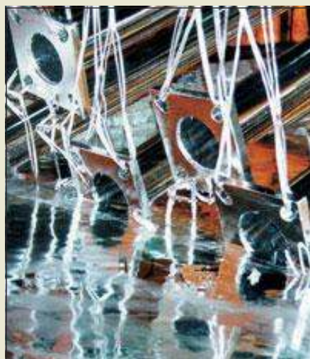
Galvanisation, où les pièces en acier sont trempées dans du zinc liquide (partie inférieure de la photographie) afin de prévenir la corrosion de l'acier.
