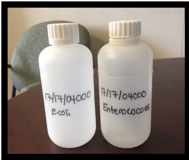
Figure 2 : Exemple de bouteilles étiquetées pour l'échantillonnage des bactéries
