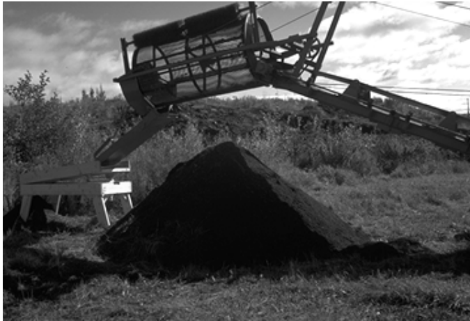
Planches 4.7 et 4.8 : Les tamis mécaniques; (haut) version 1, un tamis industriel modifié à agrégats; (bas) version 2, conçu et construit par T. MacAfee avec B. Nash et J. Keenan.
